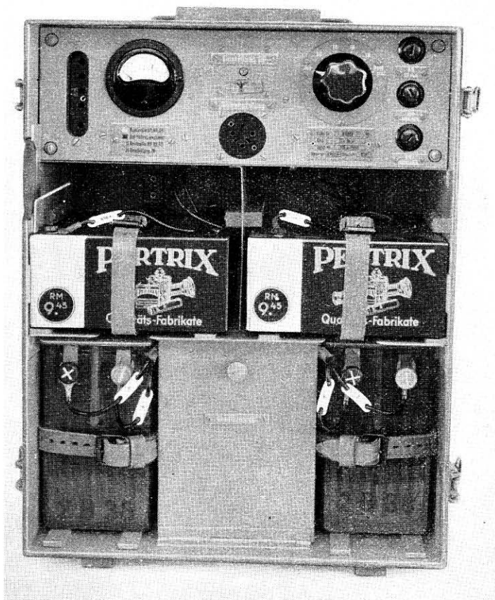
Batterien im Batterietornister
